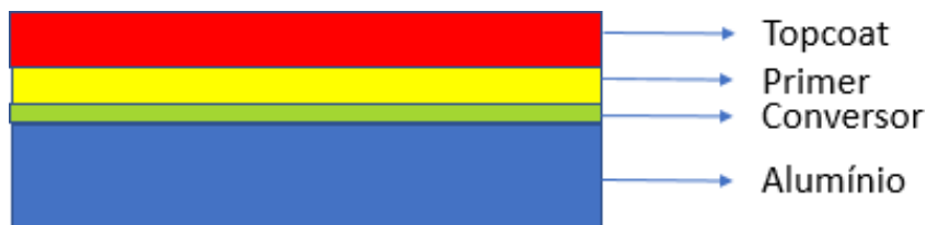
Figura 1: Esquema da pintura por coil coating.
