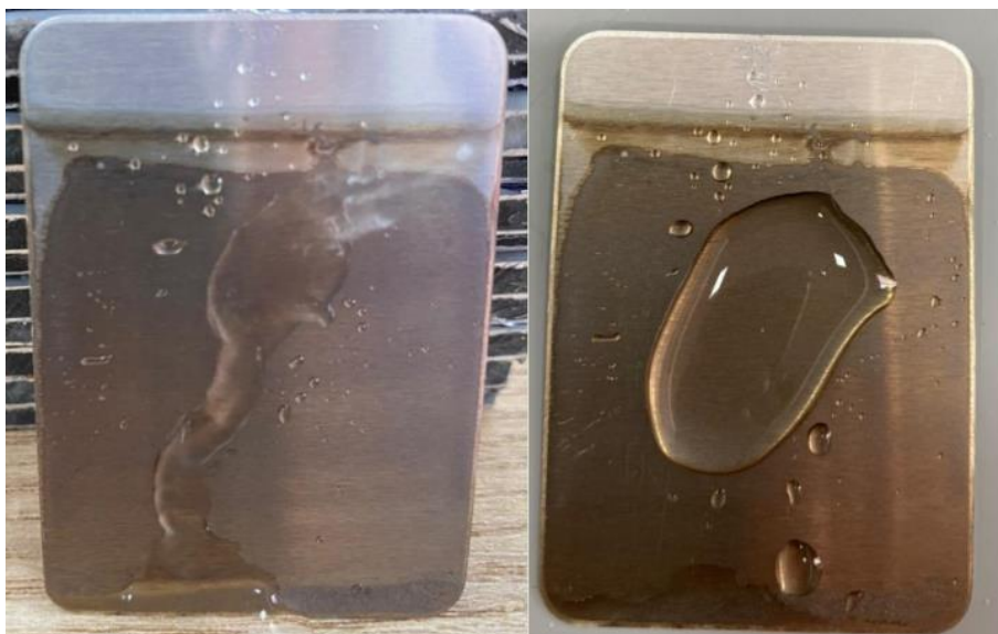
Figura 21 : Matriz com 4 camadas de óxido de cobre, inclinada a 45° e 0° graus, após ser adicionada água em sua superfície.
