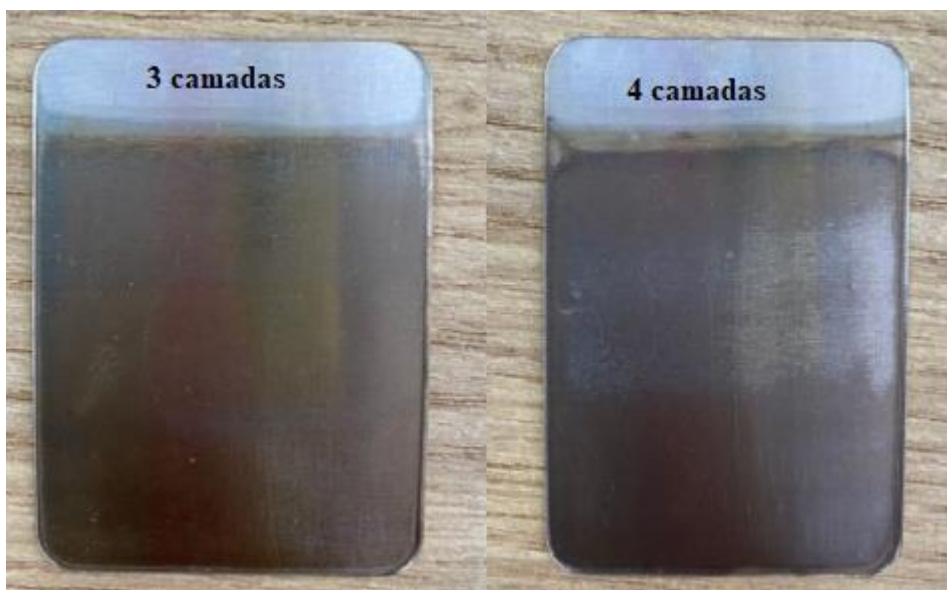
Figura 13 : Placas com 3 e 4 camadas, após o teste de abrasividade.
