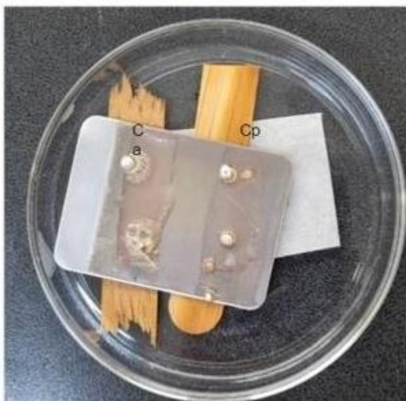
Figura 28: Placa de alumínio com 3 camada de óxido de cobre com os fugos candida albicans (ca) e candida parapsilosis (cp).
