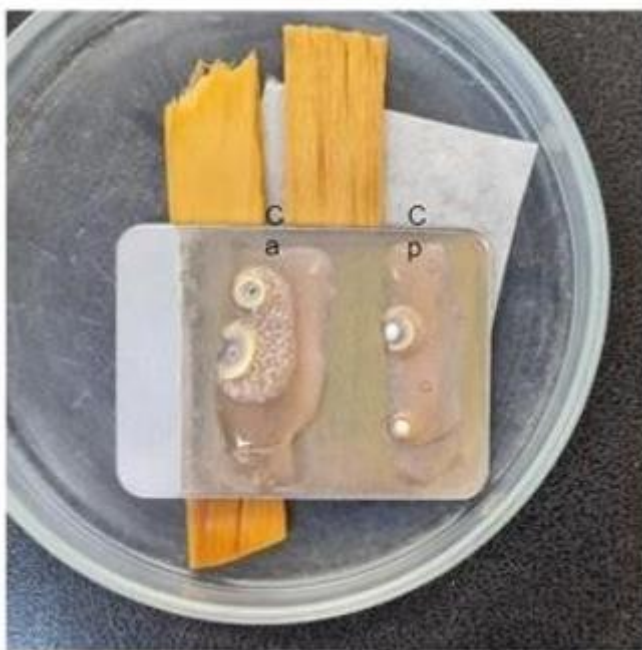
Figura 30: Placa de alumínio com 4 camada de óxido de cobre com os fugos candida albicans (ca) e candida parapsilosis (cp).
