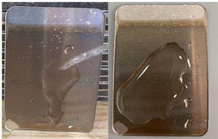
Figura 18 : Matriz com 2 camadas de óxido de cobre, inclinada a 45° e 0° graus, após ser adicionada água em sua superfície.
