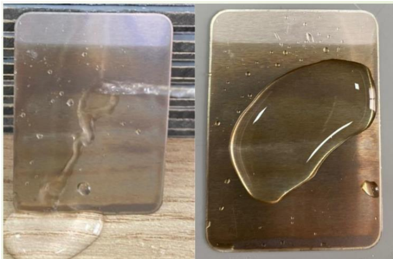
Figura 17 : Matriz com 1 camada de óxido de cobre, inclinada a 45° e 0° graus, após ser adicionada água em sua superfície.
