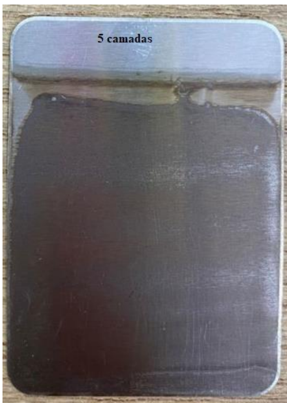
Figura 14 : Placa com 5 camadas, após o teste de abrasividade.
