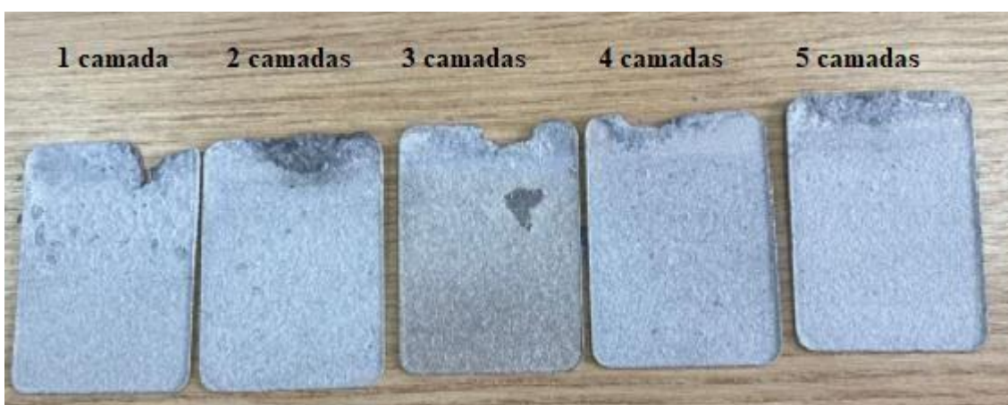
Figura 16: Matrizes de alumínio com 1,2,3,4 e 5 camadas de óxido de cobre, após as 500 horas na câmara de corrosão.
