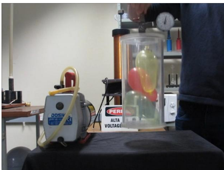
Figura 5– Câmara de vácuo sendo levantada pelo bico de acoplar mangueira da tampa.
