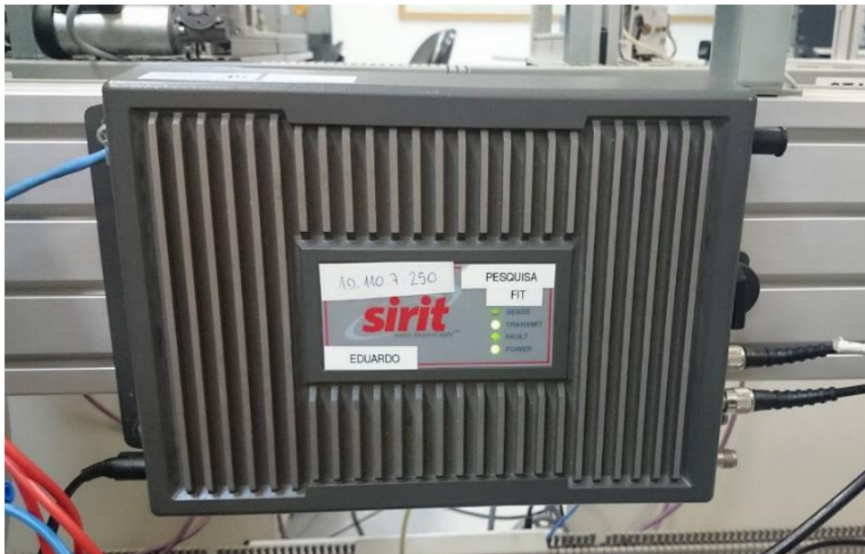
Figura 17 - Leitor fixado junto ao FMS
