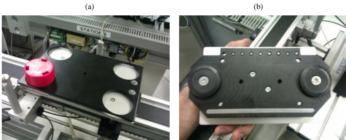
Figura 6 - (a) Imagem vista de cima do pallet do FMS, (b) Imagem de baixo do pallet
