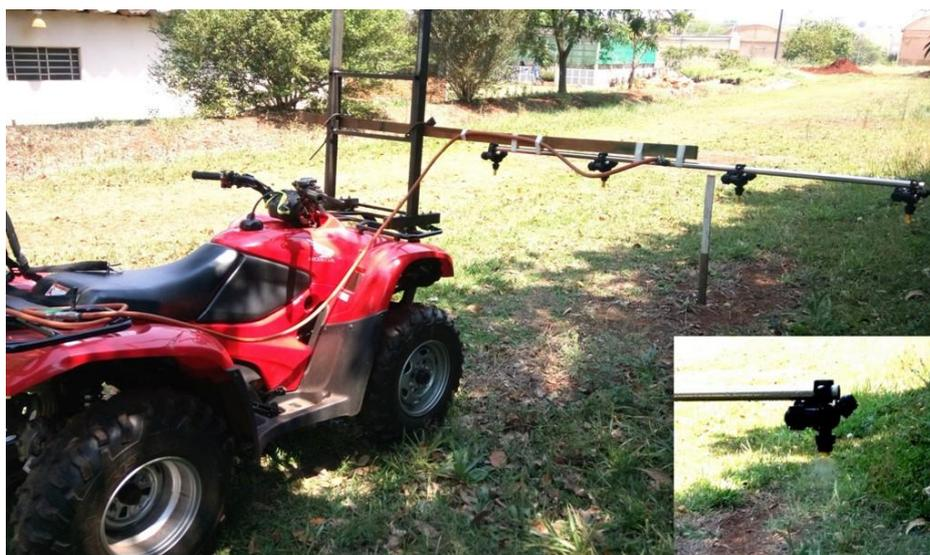
**Figura 1** – Quadriciclo adaptado com barra de pulverização para a realização das aplicações dos experimentos.
