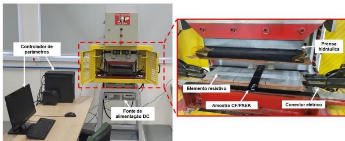
Figura 22 - Sistema experimental de soldagem utilizado.
