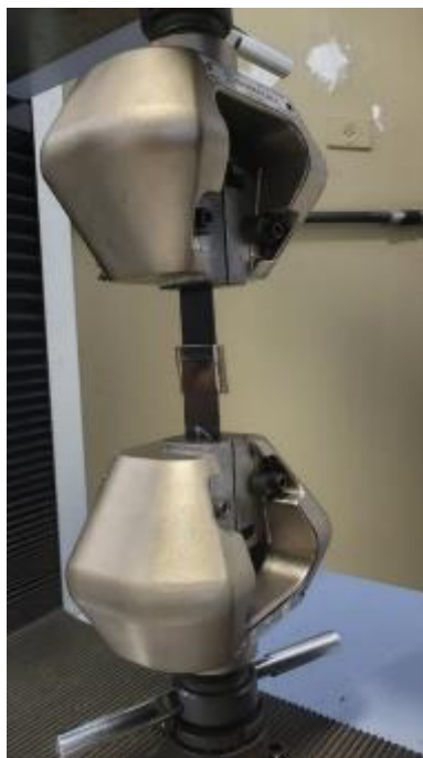
Figura 23 - Setup experimental para o ensaio de Lap Shear (LSS) e amostra soldada de semipreg de CF/PAEK.
