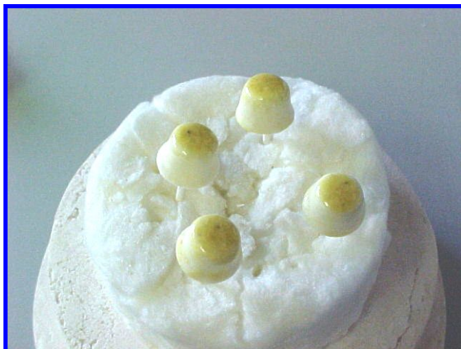
Figura 43: infiltração de vidro
