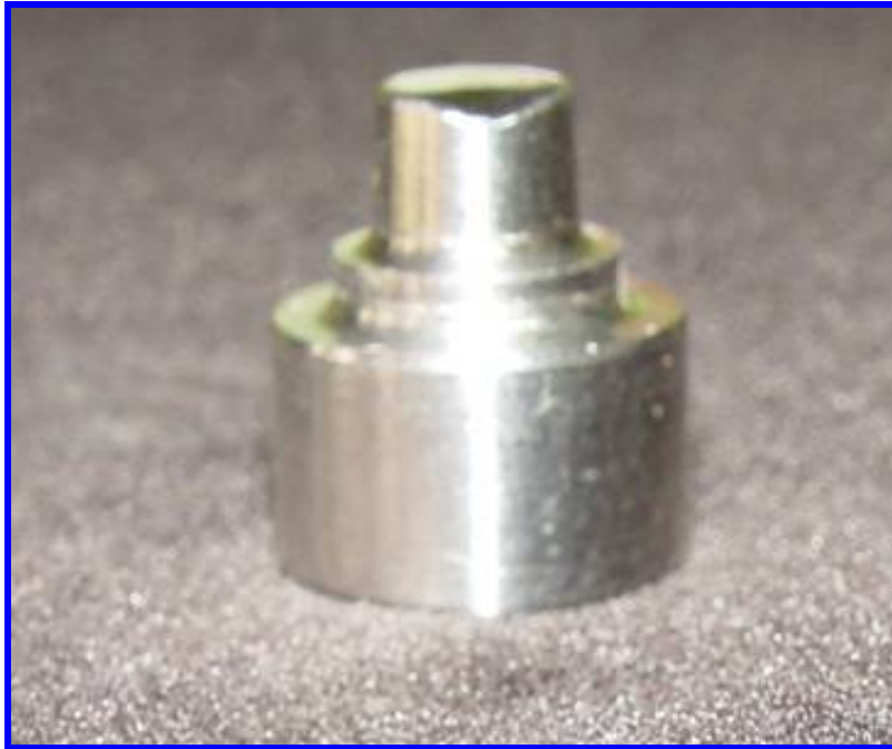
FIGURA 1: Munhão de aço que simula o preparo dental.
