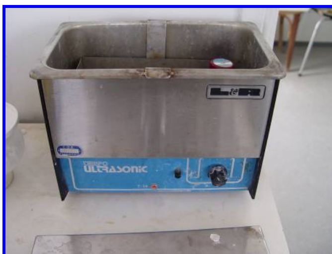
Figura 27: Ultra Som para remoção dos restos de revestimento
