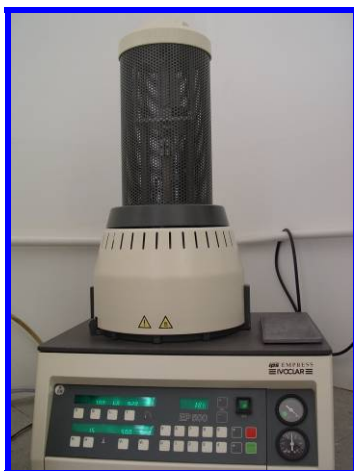
Figura 21: Apresentação do forno IPS Empress
