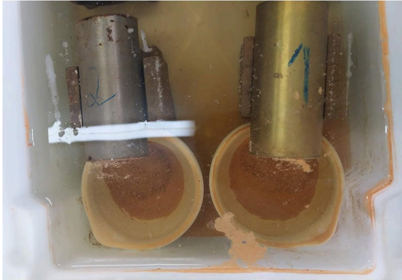
Figura 9 - Ensaio de Perda de Massa por Imersão
