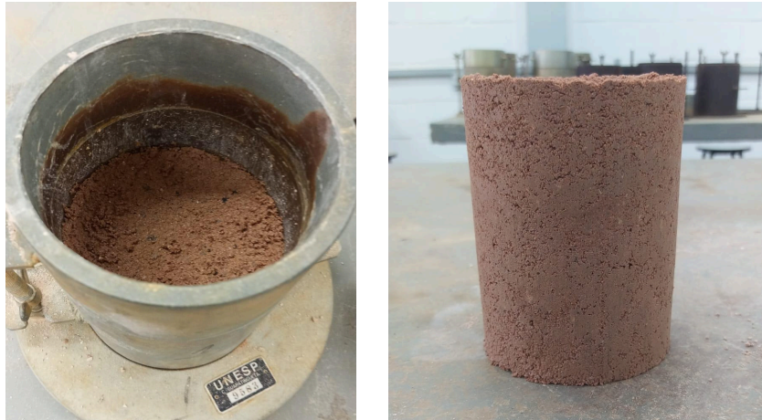
Figura 10 - Ensaio de compactação do solo
