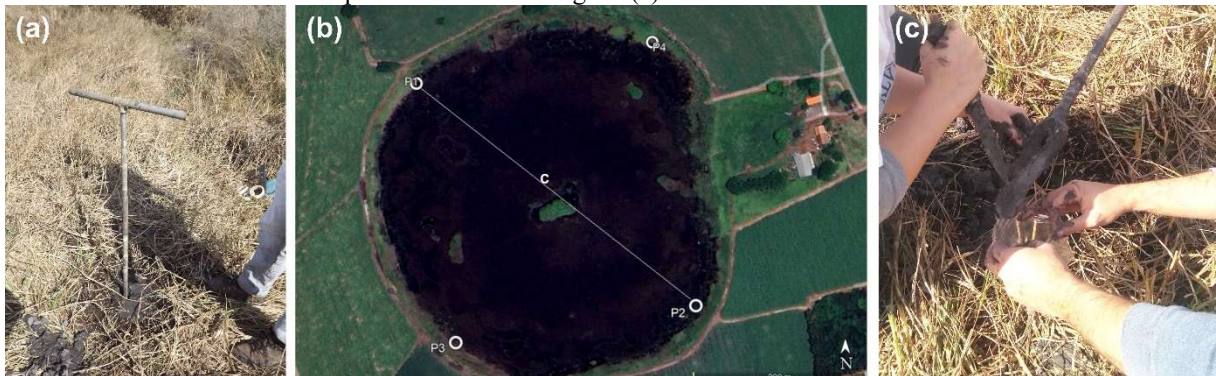
Figura 9 – (a) Poços perfurados com trado manual. (b) Localização dos poços perfurados e transecto P1-C-P2 para análise mineralógica. (c) Coleta de amostras.
