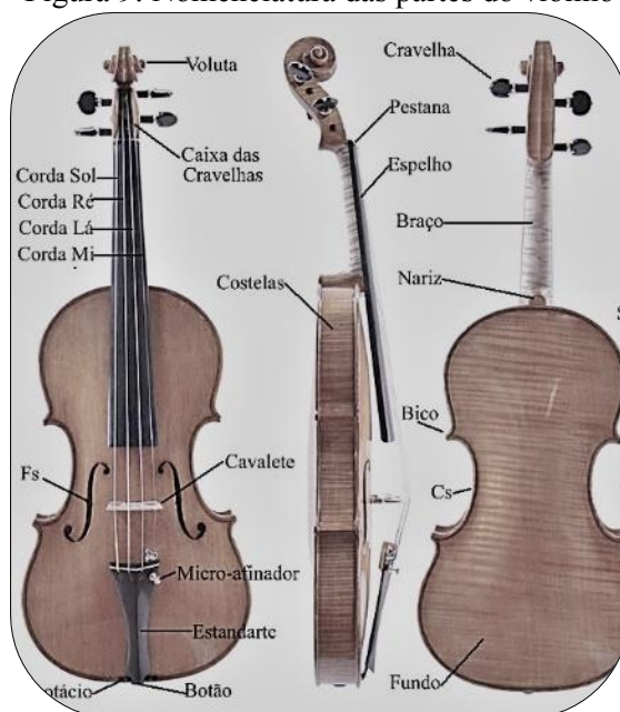
Figura 9: Nomenclatura das partes do violino
