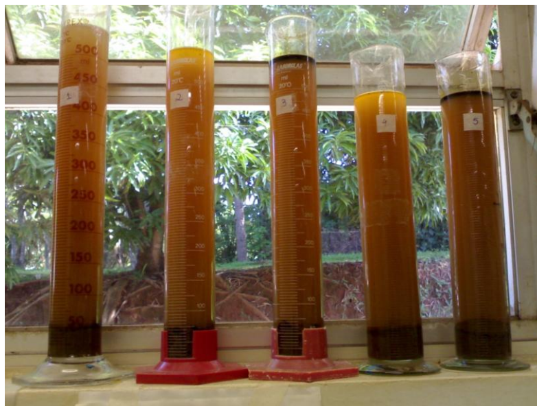
Figura 03: Colunas de Winogradsky após a montagem.
