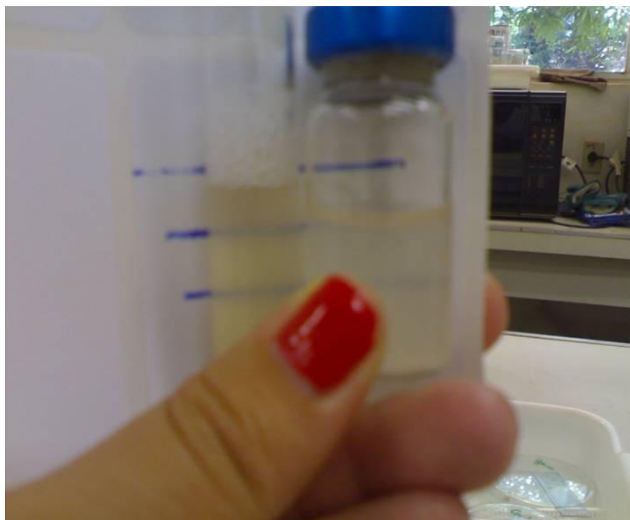
Figura 02: Comparação do Inóculo com a Escala de McFarland.
