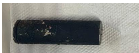
Figura 5 — Células após a submersão em solução salina para o primeiro experimento utilizando \text{MgSO}_4 \cdot 7\text{H}_2\text{O} .
