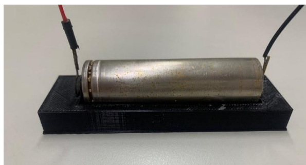
Figura 3 — Vista do suporte com a célula e a mola acoplada.
