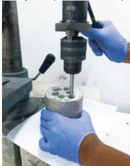
Figura 25: Extração do pó em camadas pré-definidas.
