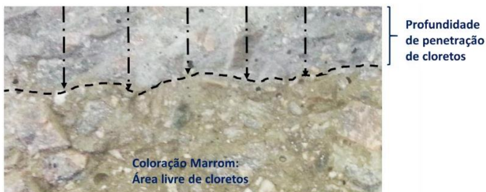
Figura 21: Contraste entre cores em amostra de concreto após aspersão de nitrato de prata.
