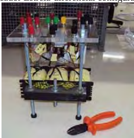
Figura 148 - Retificador Estrela-diferencial configuração A de 18 pulsos.
