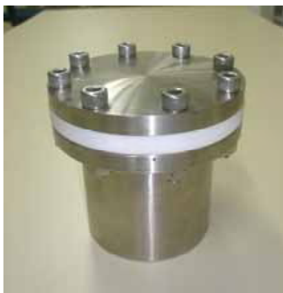
Figura 11. Bomba digestiva de aço inox 316 e teflon.
