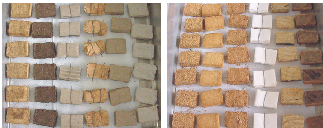
FIGURA 4 - Bloquinhos de substratos pré-moldados em forma de paralelepípedo (3,5cm de comprimento x 2,5cm de largura x 1cm de altura) antes de serem levados para a estufa.
