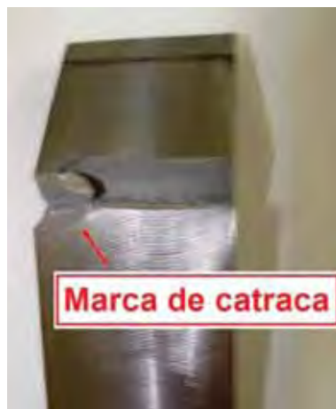
Figura 4.6 - Corpo de prova de aço GUF apresentando marca de catraca.
