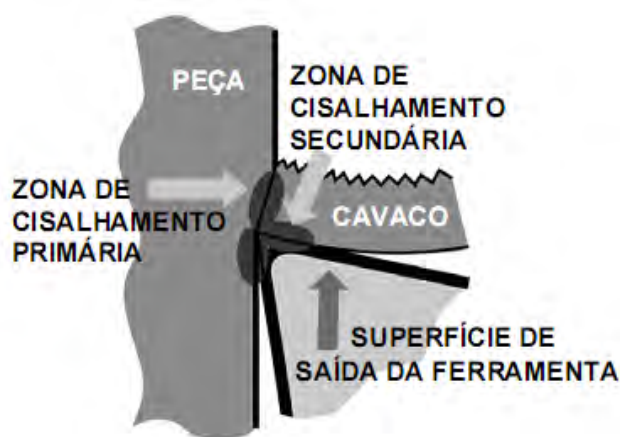
Figura 2.4 - Disposição peça-ferramenta-cavaco e zonas de cisalhamento. Fonte: Sandvik Coromant (2000).
