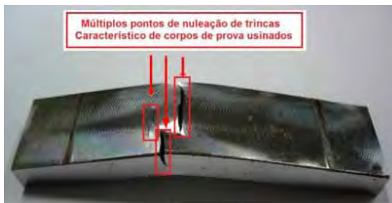
Figura 4.5 - Corpo de prova de aço CR apresentando mais de uma nucleação de trinca.
