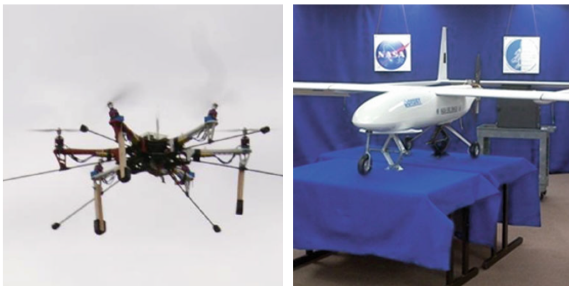
Figura 2 – UAV asa rotativa (à esquerda) e UAV asa fixa (à direita)
