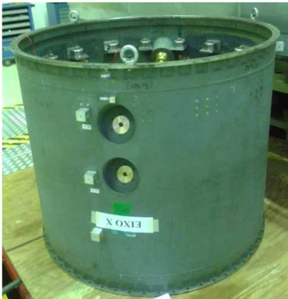
Figura 9 - Exterior da Baía de Equipamentos do VLS
