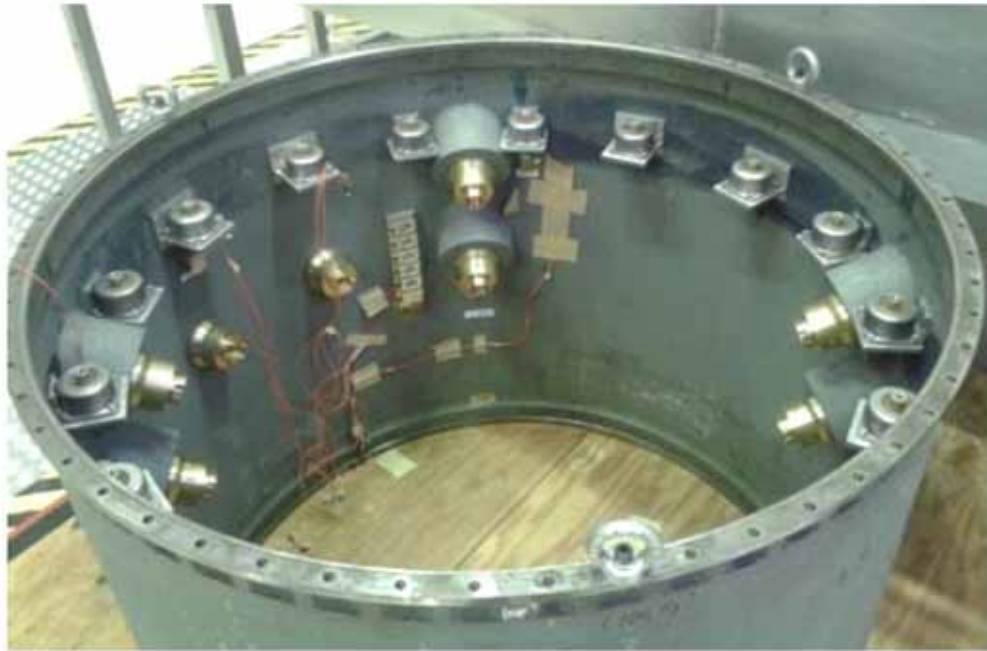
Figura 10 - Detalhes do interior da Baía de Equipamentos do VLS
