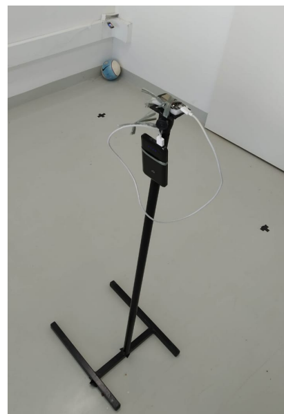
b) Suporte de medição com 1m.
