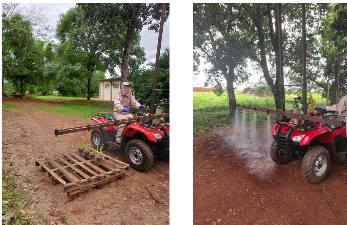
Figura 2. Aplicação com quadriciclo provido com pontas de pulverização.
