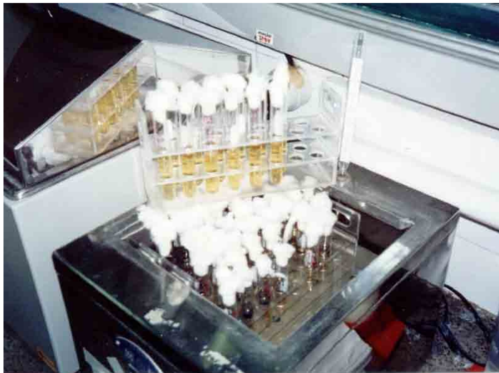
Figura 04. Tubos EC sendo incubados em banho maria a 44,5^{\circ}\text{C} \pm 0,2^{\circ}\text{C} durante 24 horas \pm 2 horas.
