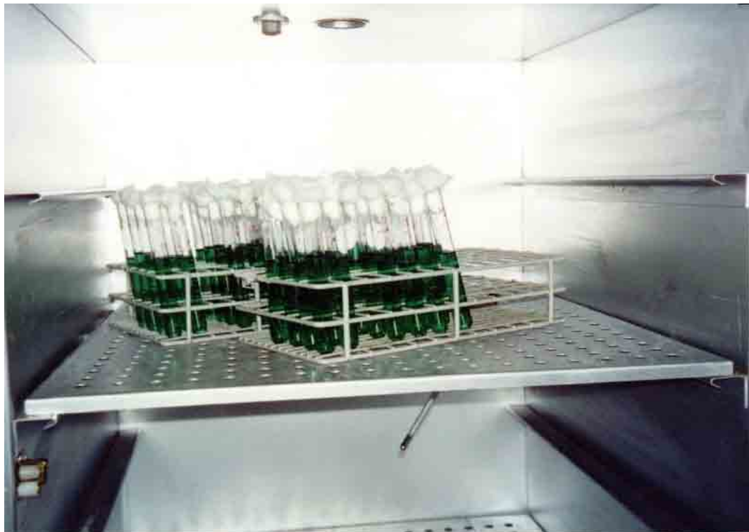
Figura 03. Os tubos de caldo bile verde brilhante sementeados sendo incubados em estufa bacteriológica a 35^{\circ}\text{C} \pm 0,5^{\circ}\text{C} por 24 e 48 horas \pm 3 horas.
