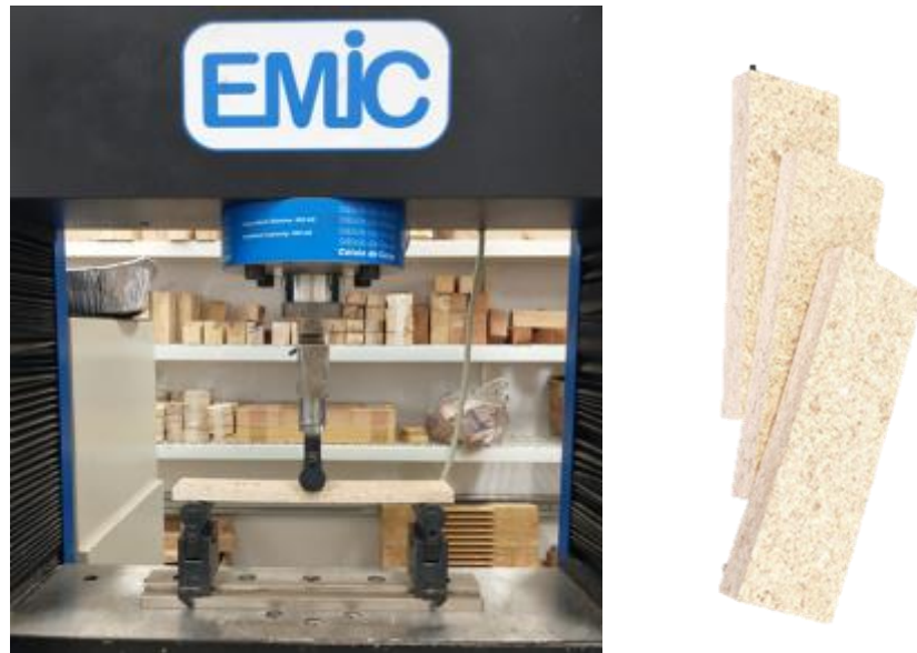
Figura 21 – Ensaio de resistência à flexão e módulo de elasticidade e corpos de prova.
