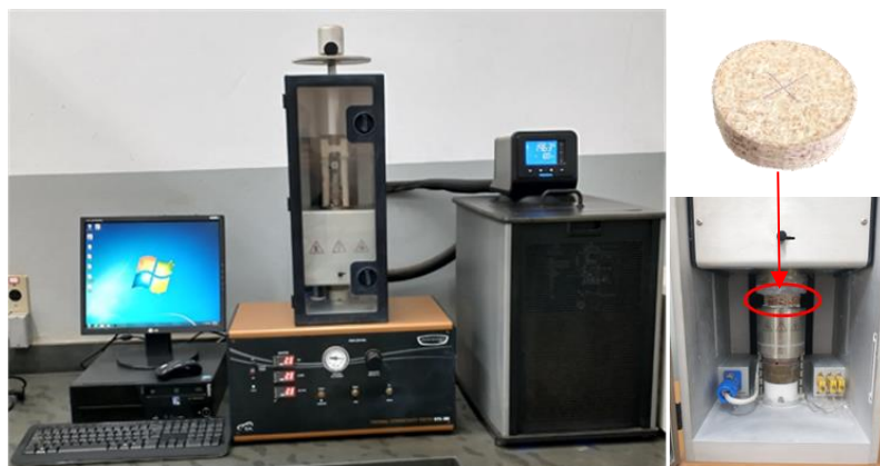
Figura 25 – Corpos de prova e ensaio de condutividade térmica.
