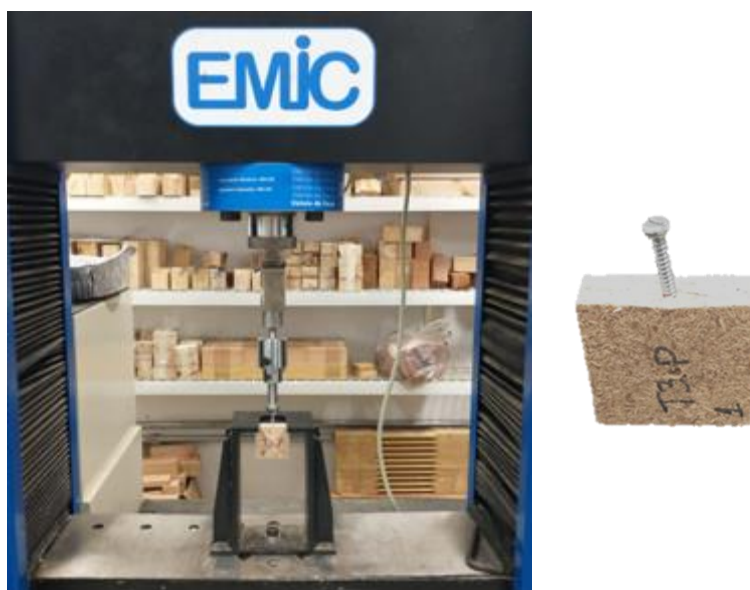
Figura 24 – Ensaio de arrancamento de parafuso no topo e corpo de prova.
