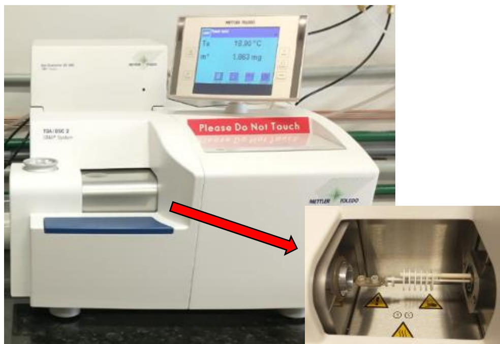
Figura 17 - Analisador termogravimétrico TGA/DSC2 e porta-amostra.
