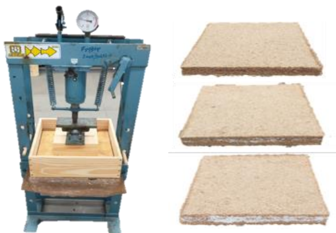
Figura 9 – Formação do colchão de partículas e colchões com 0% EPS, 12,5% EPS e 25% EPS, respectivamente.
