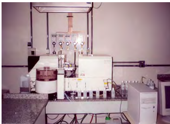
Figura 6 – Aparelho de espectrofotômetro de absorção atômica com forno de grafite (análise de crômio).
