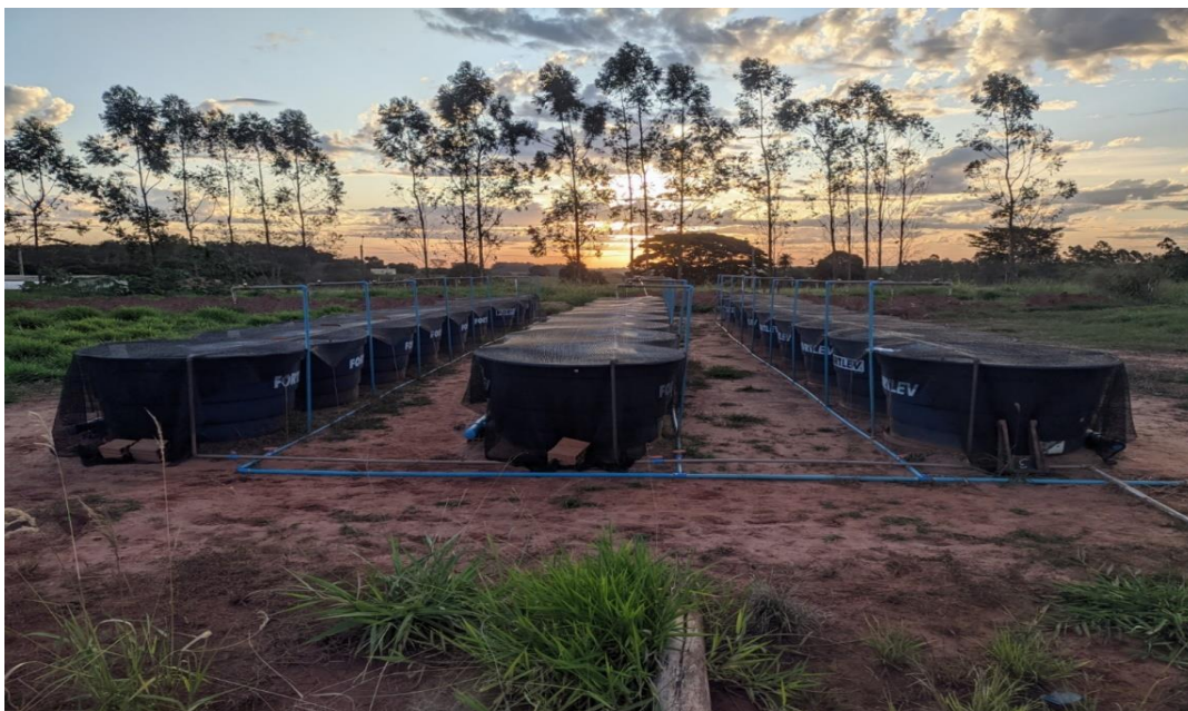
Figura 1- Sistema experimental com 24 caixas de 1.000 L com entrada e saída de água individual e aerador acoplado a tubos de PVC utilizadas para condução do experimento.
