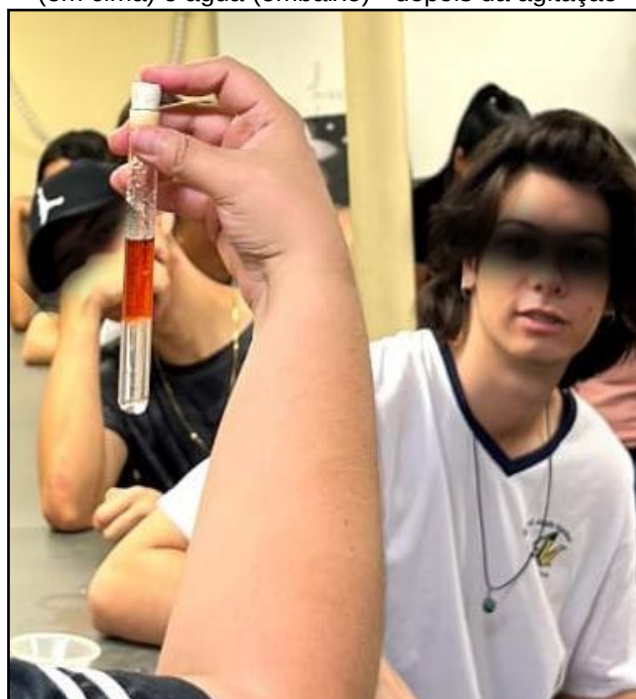
Figura 34 – Tubo de ensaio com aguarrás e iodo metalóide dissolvido (em cima) e água (embaixo) - depois da agitação
