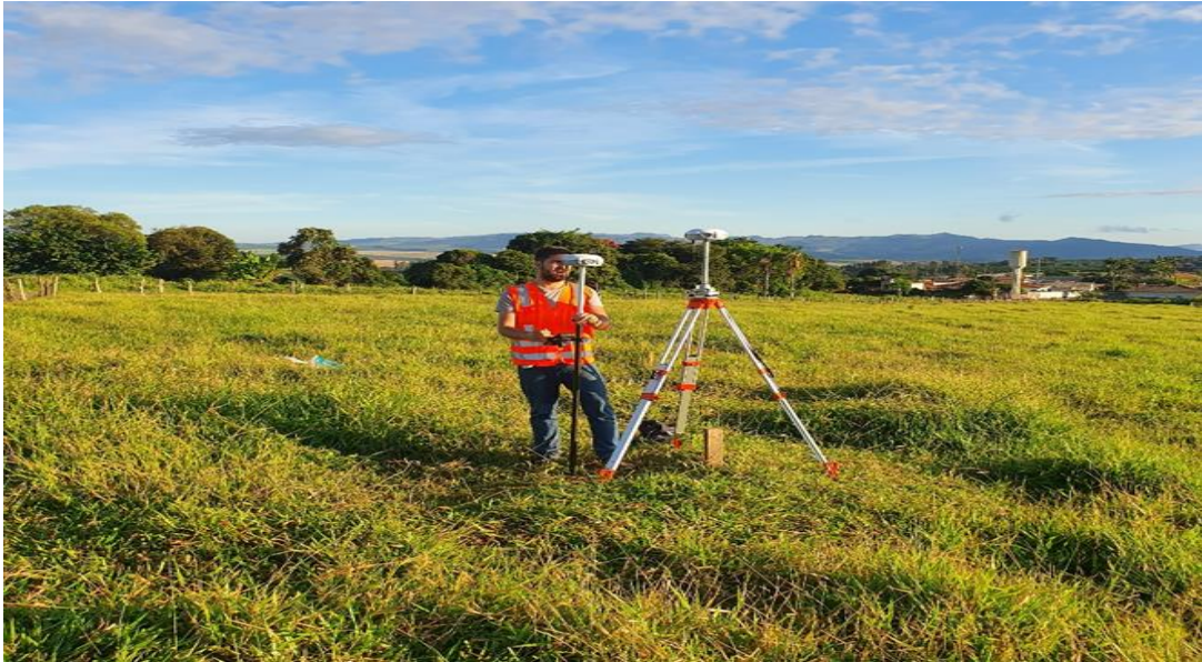
Figura 11 – Demarcação de ponto no terreno registrado por GPS.
