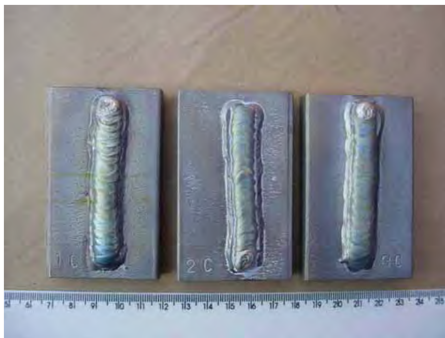
Figura 4.1- Macrografia apontando o aspecto visual do revestimento para as amostras 1,2 e 3 na condição de resfriamento “C”.
