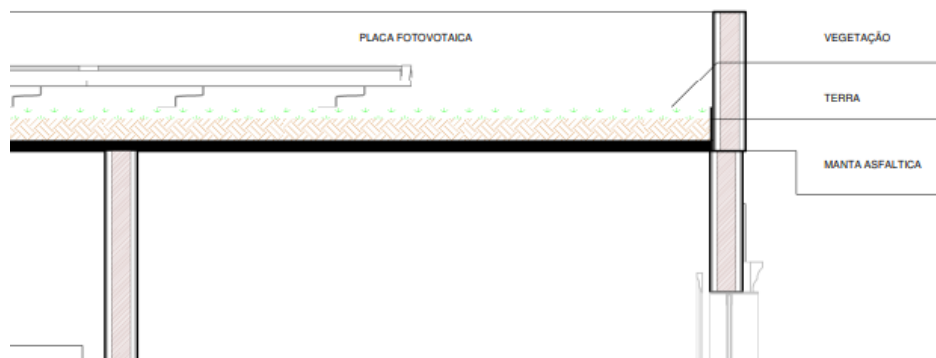
Figura 11 – Corte de Detalhamento do Telhado Verde
