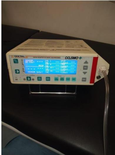
**Figura 3 - Aparelho de monitorização dos parâmetros respiratórios.**
