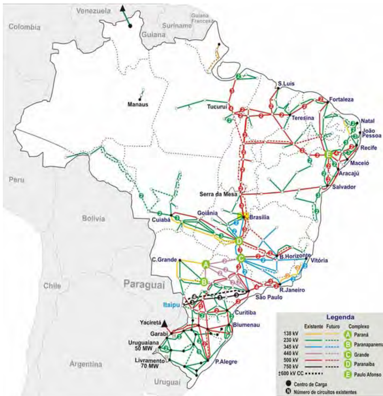
Figura 4 - Sistema de Transmissão - Horizonte 2007/2009. Fonte: ONS (2008).
