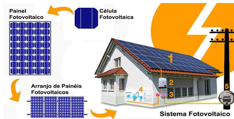
Figura 12: Demonstração da Célula e painel fotovoltaico.
