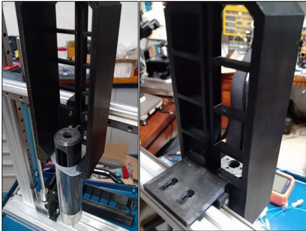
Figura 18 – Peça 1 com a seringa e peça 2 montada conforme explicado no tópico anterior.
