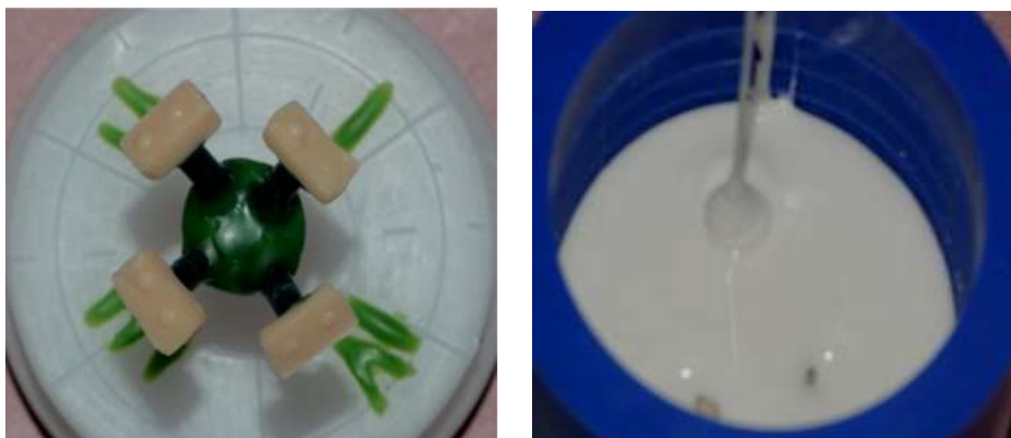
Figura 4 - Fixação e inclusão do enceramento dos corpos de prova no anel de revestimento.
