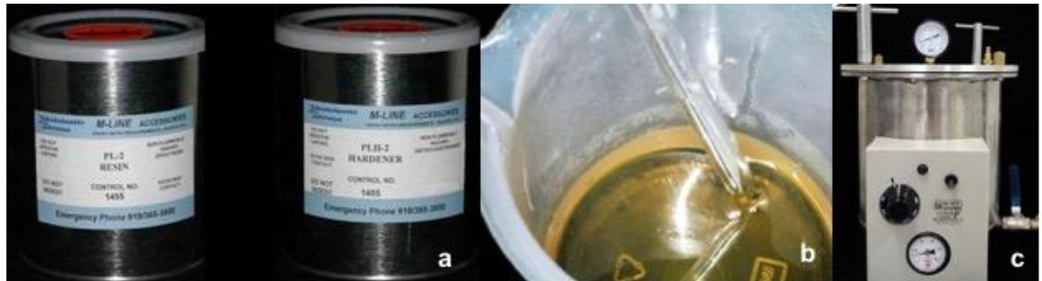
Figura 3. Resina fotoelástica PL 2 (a), manipulação e vazamento da resina fotoelástica (b) e resina sob pressão de 40 lbf/pol 2 (c).
