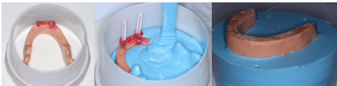
Figura 2. Moldagem com silicone fluido do modelo de gesso com os transferentes posicionados.
