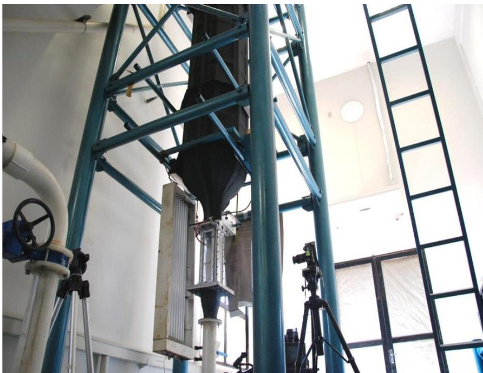
Figura 3.6 - Vista do túnel hidrodinâmico mostrando a seção de testes e parte da estrutura de sustentação.
