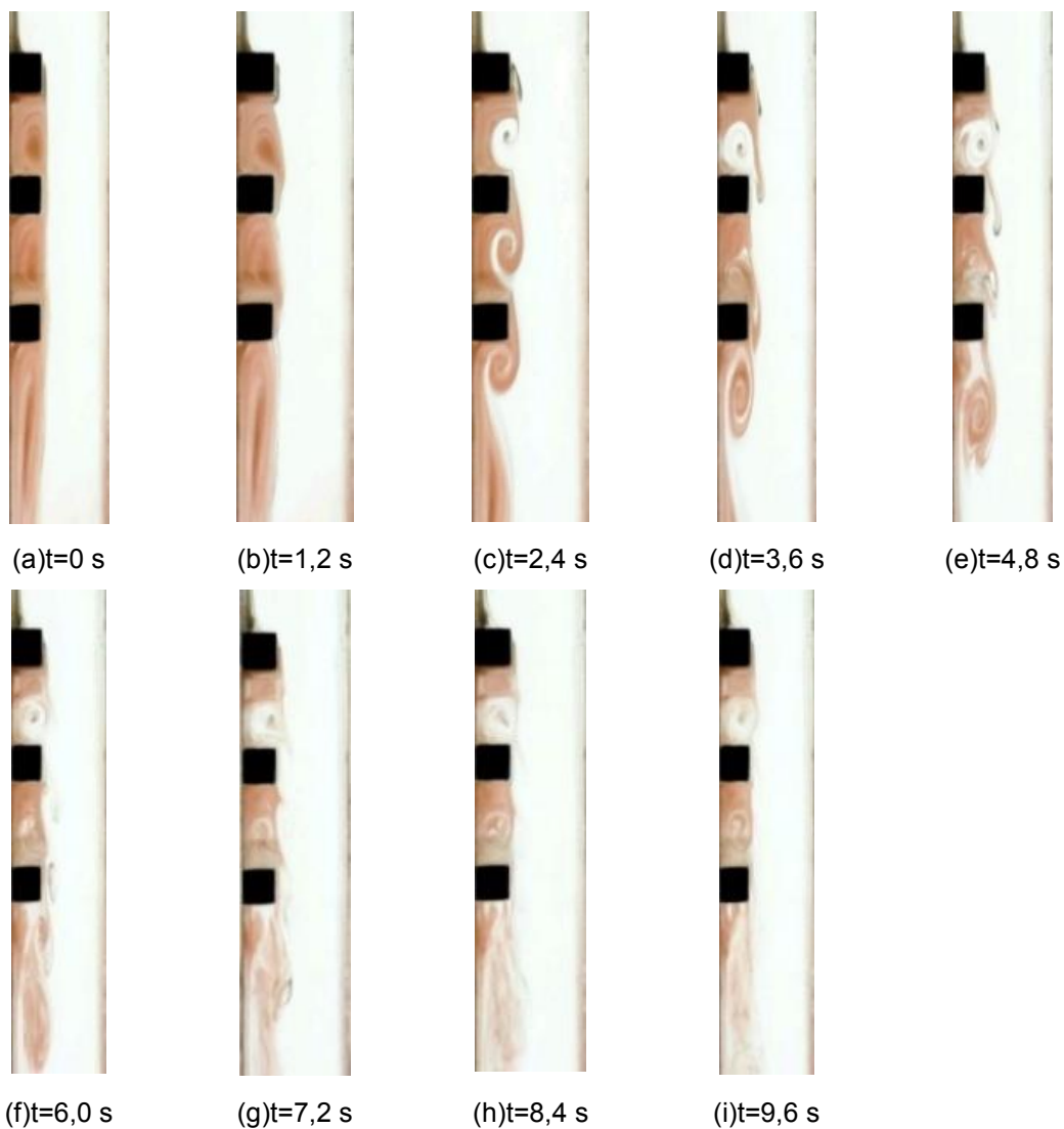
Figura 6.2 - Sequência temporal de imagens visualizadas do escoamento transiente acelerado em um canal com três protuberâncias espaçadas de 20 mm, de Re = 90 em t = 0 s a Re = 250 em t = 9,6 s.
