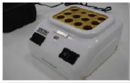
Figura 11 - Incubadora para os testes de proteína.
