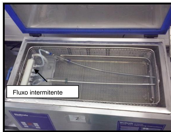
Figura 16 - Fresa adaptada à régua de fluxo intermitente da lavadora ultrassônica.
