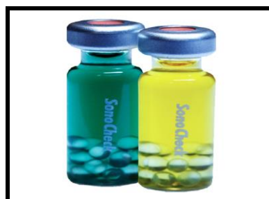
Figura 7- Teste de avaliação de funcionamento da lavadora – Sonocheck.
