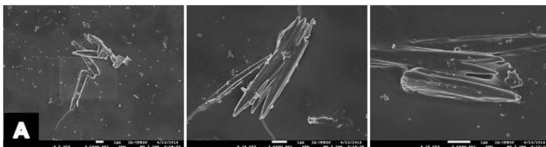
Figura 32 - Fotomicrografia obtida por MEV-FEG (5000x; 10000x e 15000x) da superfície do pó de MTX (A).
