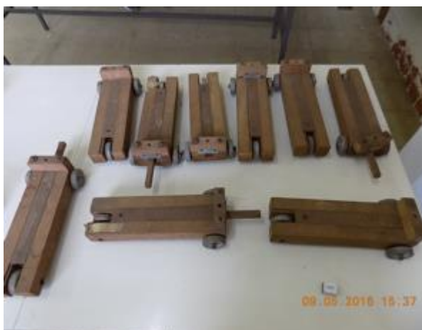
Foto 9: Carrinhos de madeira para experimentos de mecânica (movimento) foram encontrados em quantidade.
