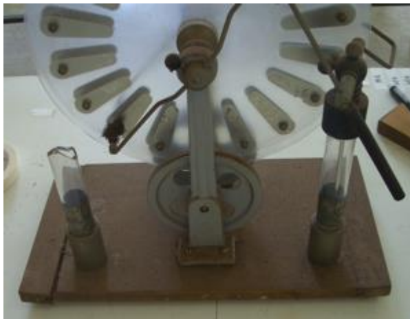
Foto 5: Máquina de Wimshurst danificada com necessidade de grandes reparos, sem uma das colunas e sem correias para as polias.
