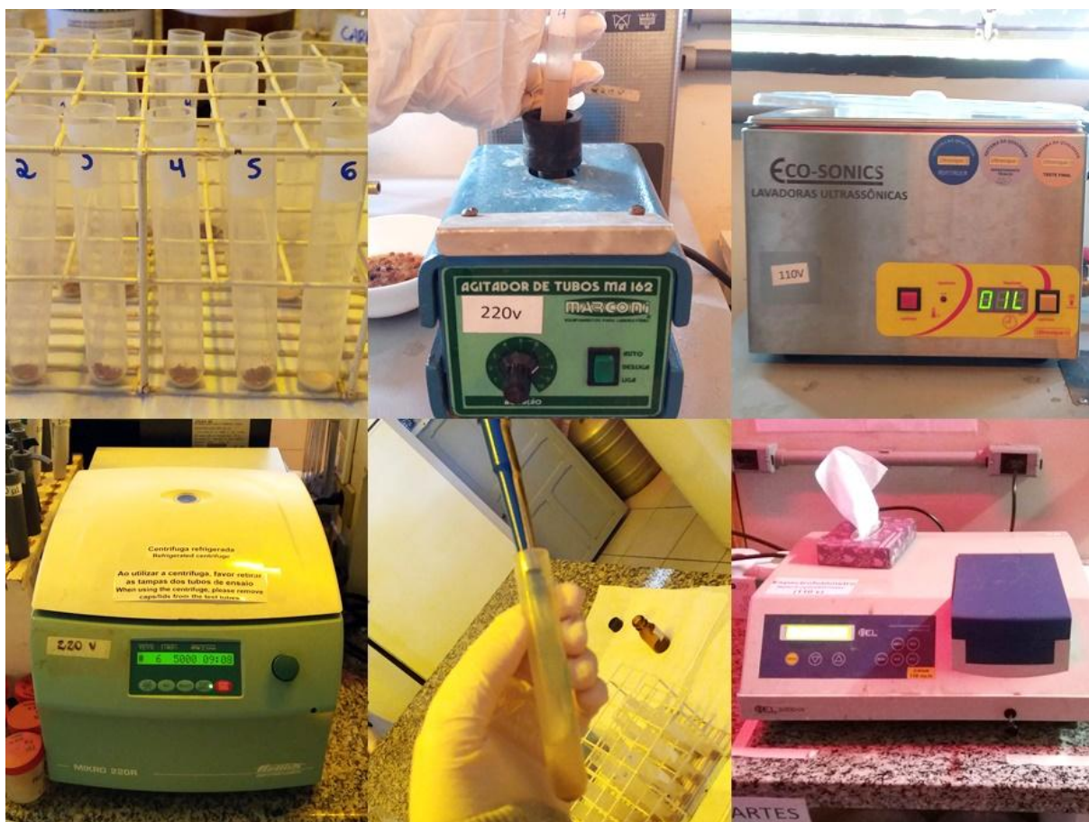
Figura 14. Etapas do processo de extração para análise de fenóis totais.
