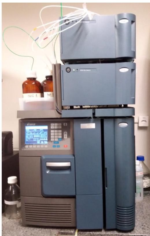
Figura 17. Equipamento de CLAE utilizado no estudo.
