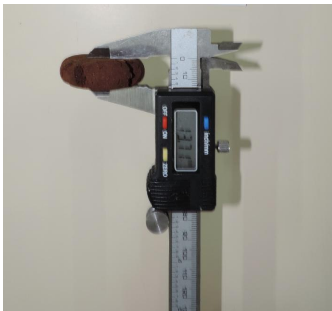
Figura 13. Paquímetro digital aferindo a espessura do biscoito.
