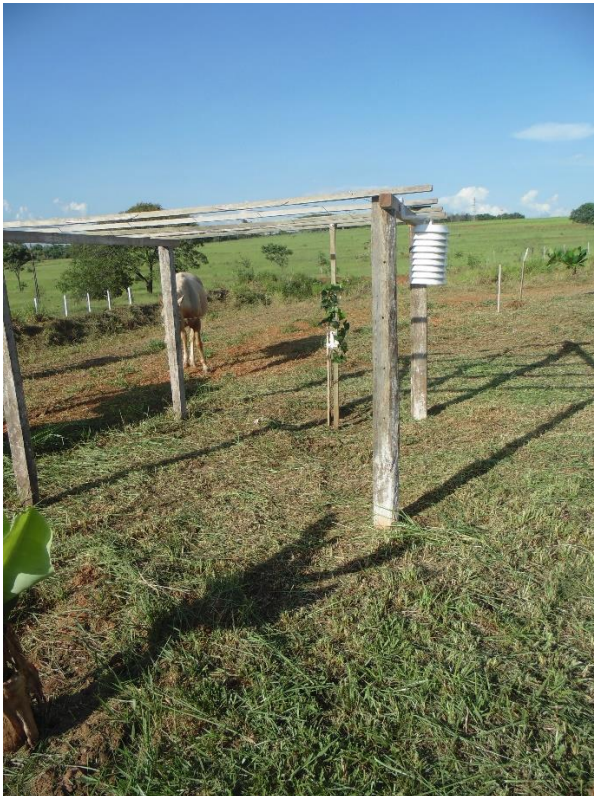
Foto 2: Abrigo meteorológico instalado em área rural de Santo Anastácio (SP).
