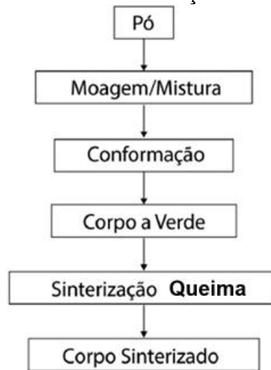
Figura 3 - Processo de fabricação das camisas cerâmicas
