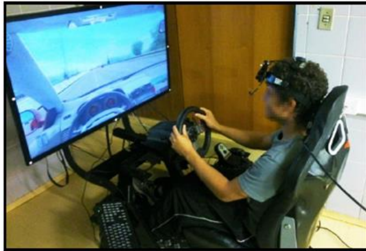
Figura 2 – Exemplo de um participante usando o rastreador ocular - Eye Tracker – durante a tarefa simulada de dirigir um automóvel no cockpit.
