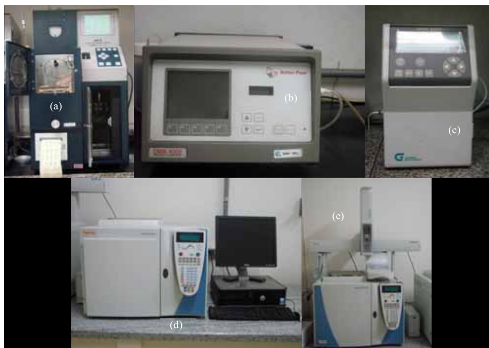
Figura 28 - Equipamentos utilizados para análises das amostras: (a) Destilador automático, (b) Densímetro eletrônico, (c) Irox, (d) Cromatógrafo a gás com módulo ultrarrápido acoplado, (e) Amostrador automático.
