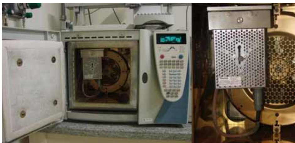
Figura 29 - Módulo ultrarrápido acoplado em um cromatógrafo a gás.
