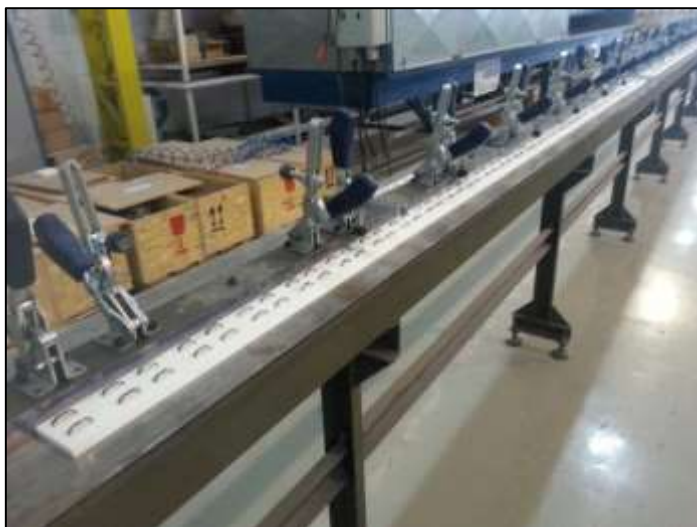
Figura 20 – Segmentos de cerâmica com clips no dispositivo de montagem
