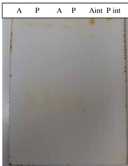
Figura 4.27. Perfil cromatográfico obtido de FLU-SQR e cápsula. Fase móvel: acetona: acetato de amônio 154 g/L, pH 5,0 (70:30, v/v), após 30 minutos de aquecimento com \text{H}_2\text{O}_2 3%. Agente revelador: vapor de iodo. (P = SQR; A = amostra; int = solução íntegra).
