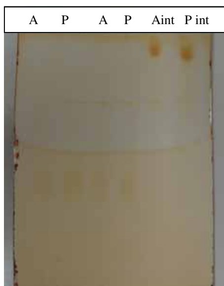
Figura 4.28. Perfil cromatográfico obtido de FLU-SQR e cápsula. Fase móvel: acetona: acetato de amônio 154 g/L, pH 5,0 (70:30, v/v), após 60 minutos de aquecimento com \text{H}_2\text{O}_2 3%. Agente revelador: vapor de iodo. (P = SQR; A = amostra; int = solução íntegra).
