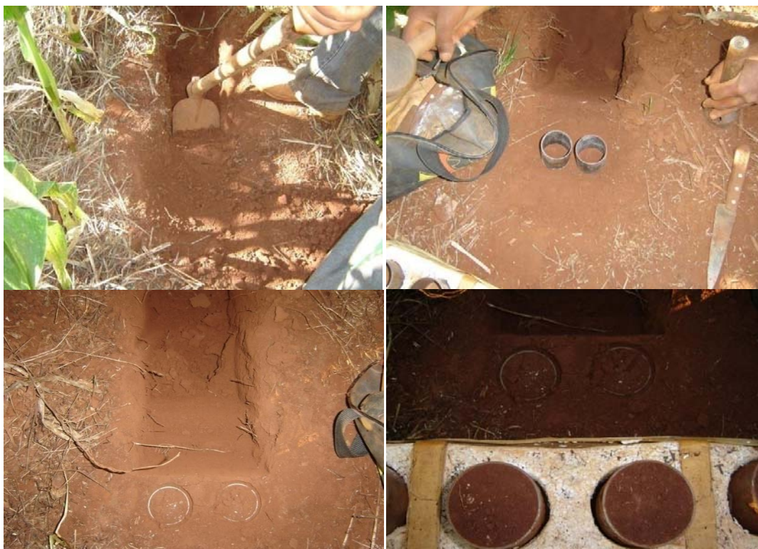
Figura 14B. Sequência da coleta de solo com cilindros para a determinação das propriedades físicas do solo.
