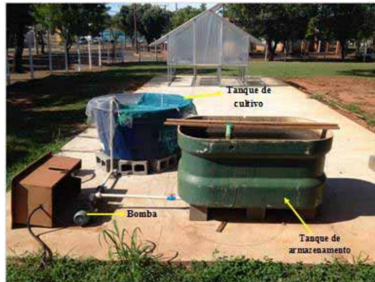
Figura 4 - Sistema de tratamento com lemnas adotado em Garcia (2015) e Garcia, Albertin e Matsumoto (2017)
