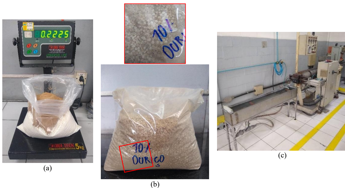
Figura 4.7: a) Pesagem dos biocompósitos, b) Agregação dos pellets de PBAT com as partículas do ouriço da castanha e c) Extrusora.
