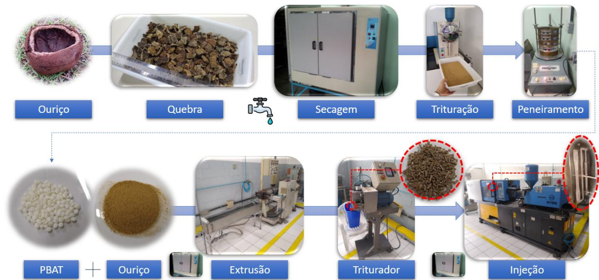
Figura 4.3: Resumo esquemático da preparação dos biocompósitos.
