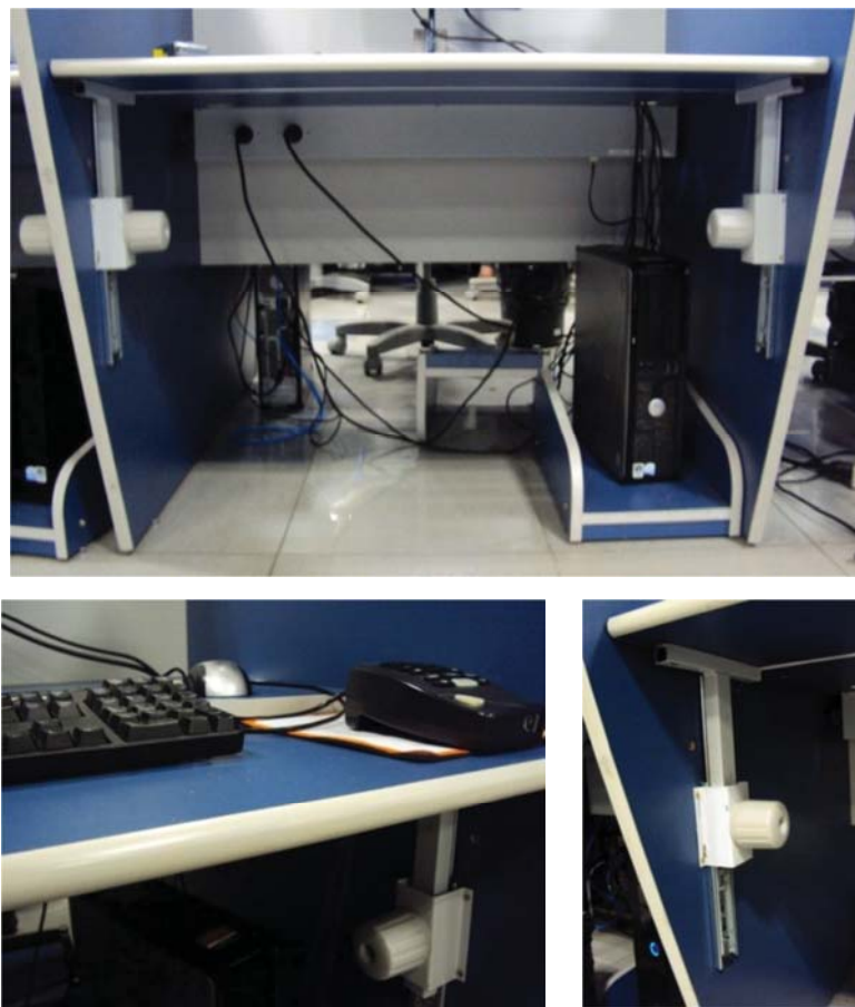
Figura 89: Vista da área horizontal de trabalho e sistema de regulagem de altura
