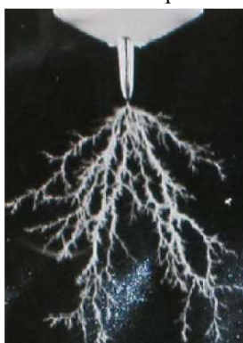
Figura 4 - Arborescência em polimetilmetacrilato.
