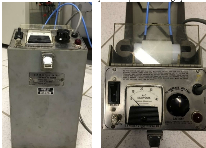
Figura 36 - Medidor de rigidez dielétrica para indução de descarga parcial nos eletrodos.
