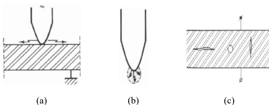
Figura 3 - Tipos de descargas parciais, segundo Mason (1995): (a) superficial; (b) externa; e (c) interna.
